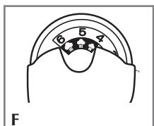
1. Llene el tanque de agua hasta alcanzar la marca de llenado MAX y ajuste el selector de tejidos entre el nivel 4 y 6, según el tejido de la prenda. Consulte la guía de tejidos debajo del talón de descanso de la plancha y lea la etiqueta de la prenda para determinar el tipo de tejido (F).
