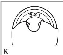
1. Mettez le cadran de sélection de tissu au réglage 1, 2 ou 3 pour repasser sans vapeur (**K**). Le système Smart Steam<sup>mc</sup> s'éteindra automatiquement.
