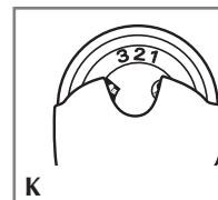
1. Ajuste el selector de tejidos a la posición 1, 2 o 3 a fin de planchar sin vapor (K). El sistema Smart Steam™ se apaga automáticamente.
