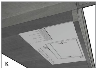
**Important :** Ne pas aligner les trous de vis sur le gabarit avec l'espace entre les armoires, car cela vous empêcherait d'installer l'appareil correctement. Choisir l'emplacement des trous de perçage avec soin pour éviter d'endommager vos armoires pendant le montage. Le fait de percer des trous dans la cloison de vos armoires peut les endommager et nuire à l'installation adéquate de l'appareil.
